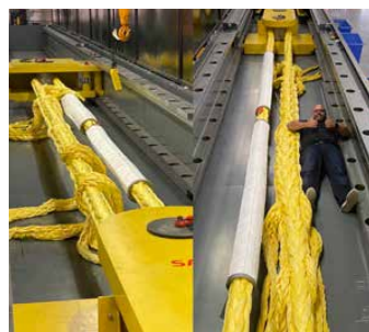
Prüfung von Faserseilen
