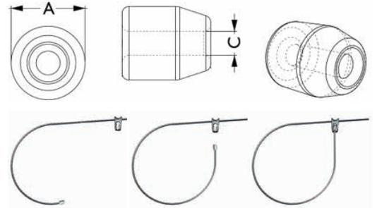
Embouts en acier pour la fabrication d'élingues de débardage. Une seule paire de matrice est nécessaire pour le manchonnage des 3 dimensions de Choker.
